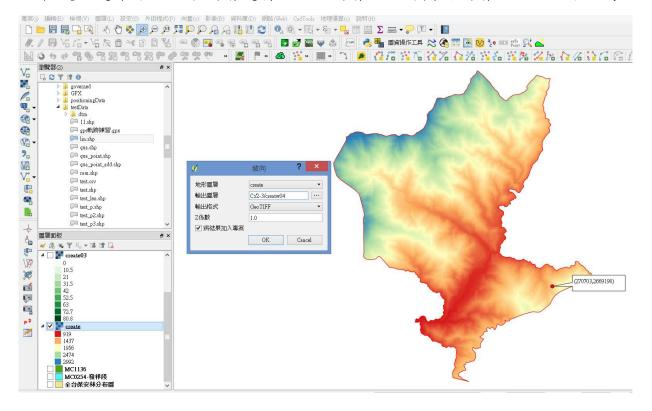
3. 即可產生坡向圖。可選擇坡向圖層,點選滑鼠右鍵,選擇屬性。
