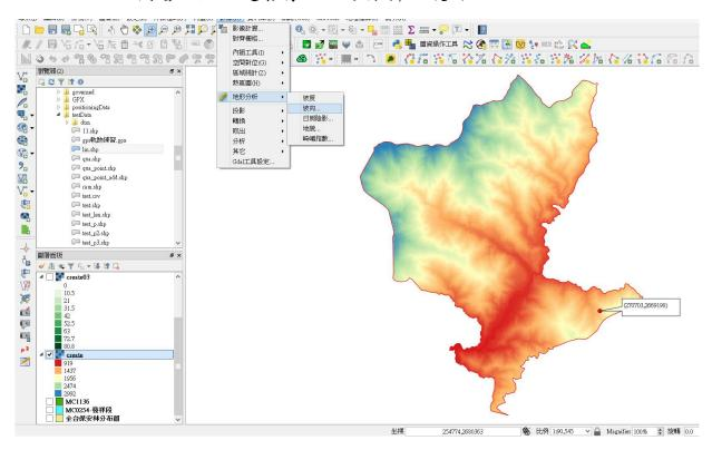
2. 在坡向選單中,地形圖層選擇 DEM 圖層,設定輸出圖層路徑,Z係數為1。
