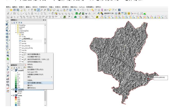
4. 進入屬性中的樣式選單,在波段繪圖選擇單波段偽彩色;並在載入最小/最大值設定中,選擇最小/最大,並點選載入。
