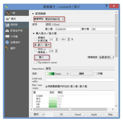
5. 在坡向分類上示範八方位分類法。故在 Interpolation 選擇離散,並設定每個方位區間坡向角度與顏色,設定好可以匯出儲存,方便未來直接使用。
