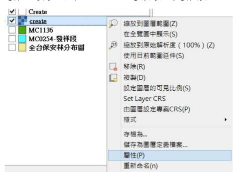
2. 進入屬性後,選擇樣式。在波段繪圖選擇單波段偽彩色;載入最小/最大值設定選擇最小/最大,並按載入;在彩色的部份可以選擇預設的彩色映射表 (色條),或點選新增彩色映射表,來新增地形表示用的色條。
